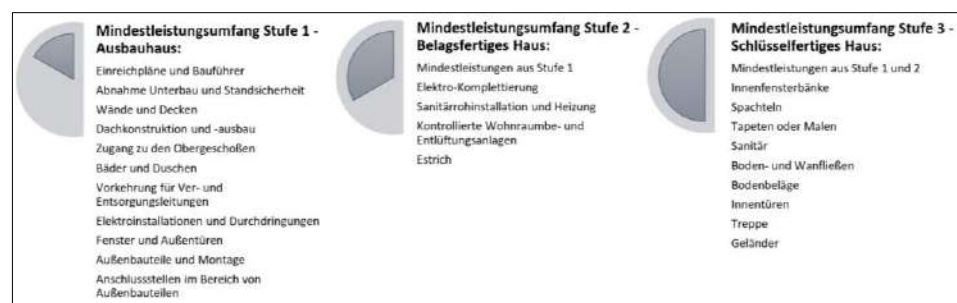
Bild I-2 Mindestleistungsumfang der Ausbaustufen lt. ÖNORM B 2310 14
