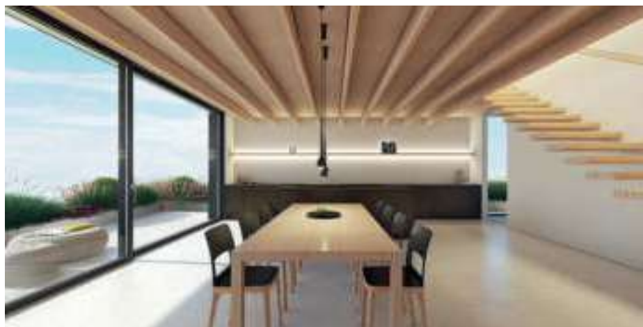
BauBuche-Paneele sind wie massives Laubholz auf Sicht zu verarbeiten. Die allseits geschliffenen Oberflächen lassen sich sehr gut weiter veredeln
